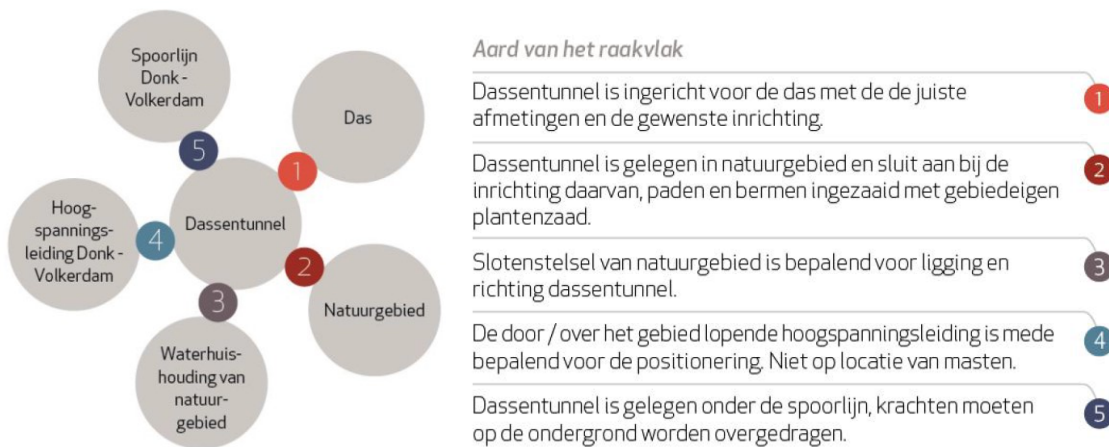
Figuur 11 – Contextdiagram voor een dassentunnel (uit Leidraad SE v3)
